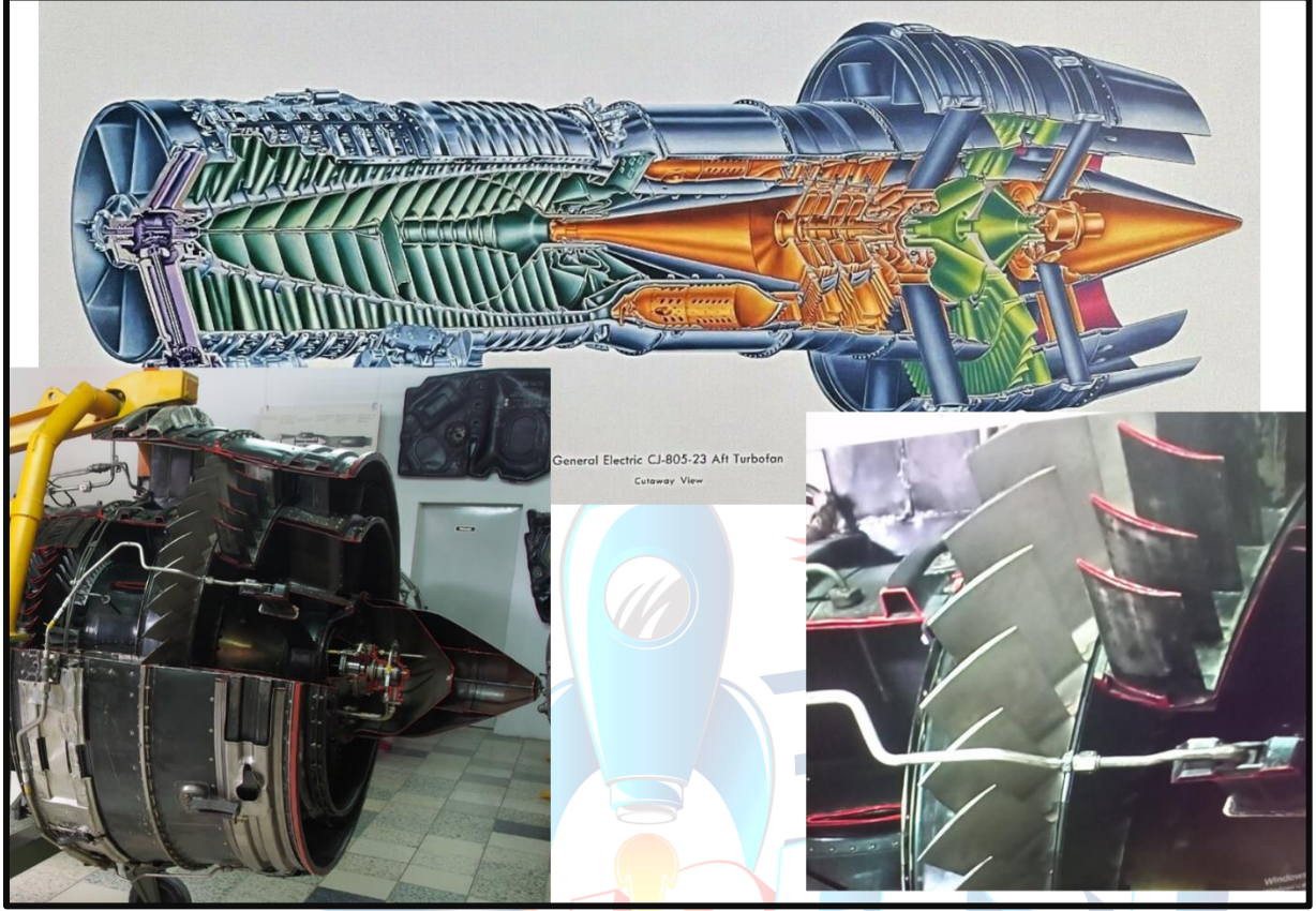
Şekil 3.3 General Electric firması üretimi CJ-805-23 aft turbofan motoru [8]
