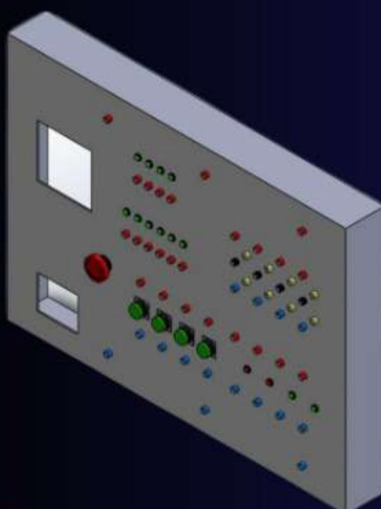
MOSTEM PLC SETİ, programlama kısmında Waltech Ladder Maker programı kullanılmıştır. Kodları, mikroişlemciye bu sayede iletilmiştir. İstenilen problemi giriş ve çıkış bağlantıları yapılarak uygulanmıştır.
