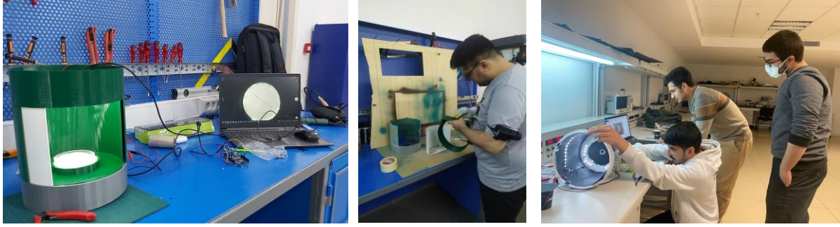
Şekil 6- A) Görüntüleme ve cihaz içi ışıklandırma çalışması B) 3D baskı sonrası Boyama çalışması C) 4 TRL seviyesindeki laboratuvar ölçekli CytoDeep prototipi
