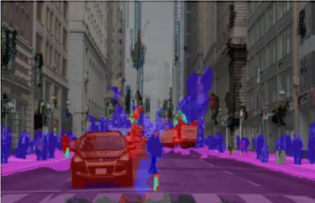
Şekil 4: Test setlerinde kullanılan bir fotoğrafa ait görüntü. Bu set Kaggle veya Google Collab tarafından sunulan veri setleridir. Şekilde koyu pembe ile gösterilen alanlar engelli birey için serbest alanlardır. Burada gösterilmek istenilen özellik yol ile kaldırım arasında ayrımın yapılabildiğidir. Şekilde aynı zamanda diğer engel oluşturacak şeylerde mavi olarak boyanmıştır.
