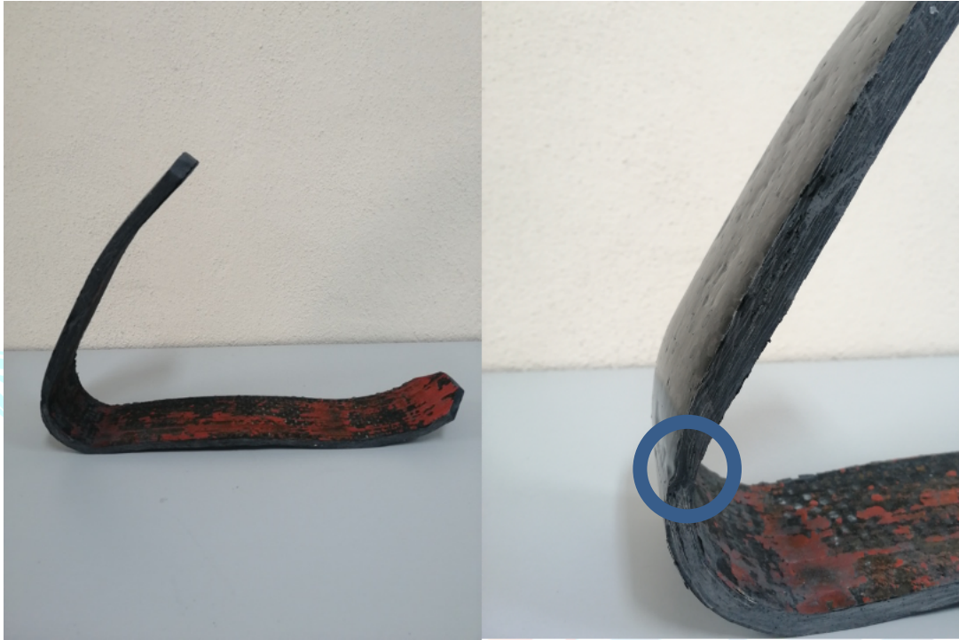
Şekil 6. (Sol) Üretilen ilk prototip. (Sağ) Geçiş bölgesinde gerçekleşen düzensiz parça kalınlığı
