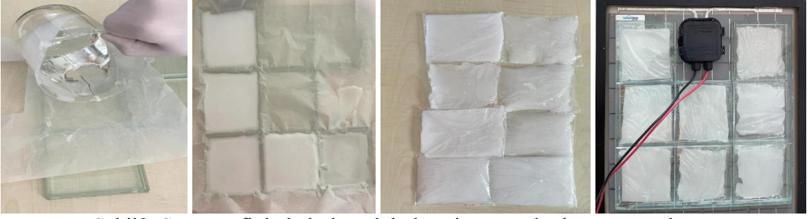
Şekil8: Sıvı parafinin kalıplara dökülmesi ve panel arkasına uygulanması.
