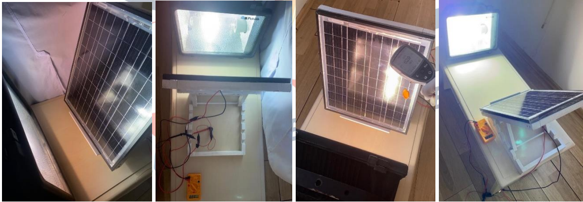
Şekil11:Al 2 O 3 mikropartiküllerinkatkılı parafimli deney düzeneğimizde multimetre ve lazer termometre ile alınan ölçümlere ait görseller.
