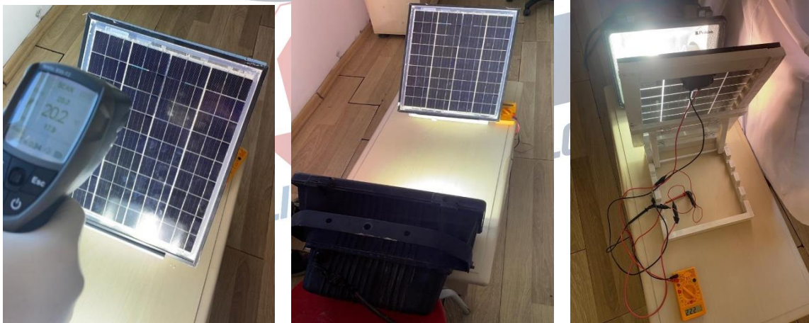
Şekil 3: Deney düzeneğimizde multimetre ve lazer termometre ile alınan ölçümlere ait görseller.
