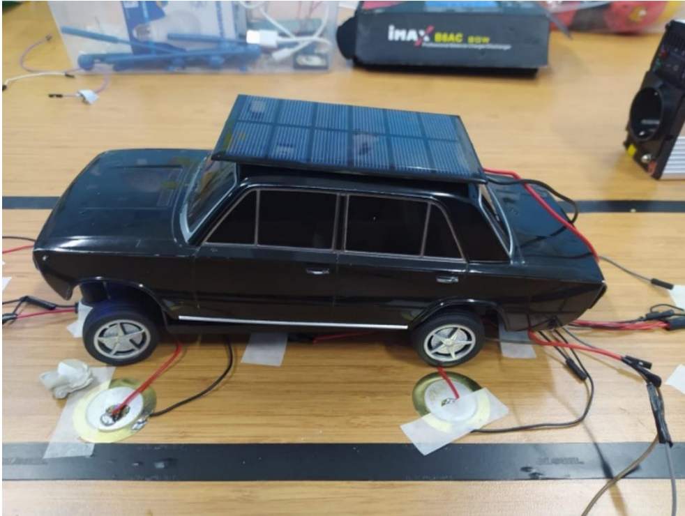
Şekil 26: Aracın Üzerindeki Güneş Paneli ile araca Enerji sağlanması
