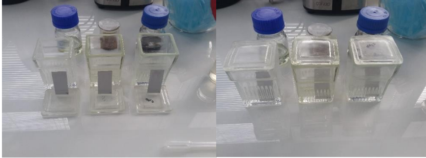
Resim 13: Numuneler damlatıldıktan sonra, oda sıcaklığında bekletilen ve daha sonra kromatografi küvetine koyulan plakalar
