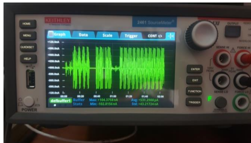
Şekil 6. Kaynakmetre kullanılarak elde edilen zamana bağlı akım ölçümleri
