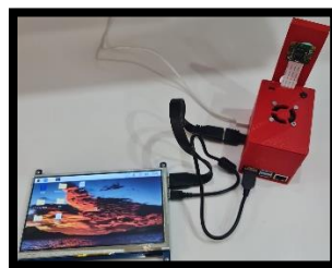
Resim 11. Yapay Zekâ kutusu ile nesne takibi için 7.1 inç ekran
