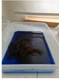
Resim 8.b Tatlı su ile hazırlanmış atık boyanın insan saçı deneyi
