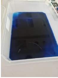
Resim 8.a Basic blue 41gr boya hazırlanmış ile 500 ml su karışımı
