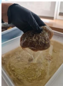
Resim 4.b Tatlı su ile insan saçının müsilaj deneyi
