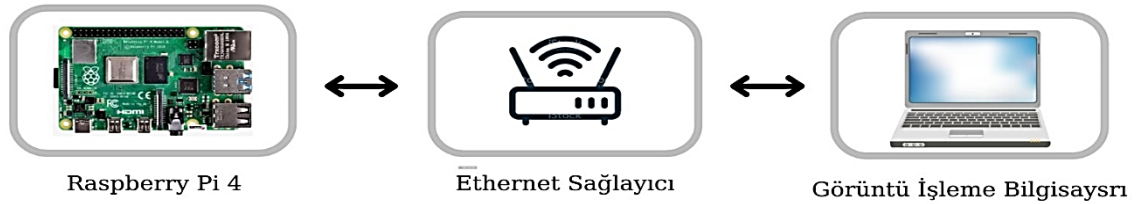
Şekil 17 Görüntü İşleme Arayüzü ve Uçuş Kontrol İstasyonu Arasındaki Haberleşme
