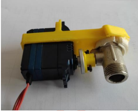
Görsel 3. Radyatör vanası kontrol motoru montajı
