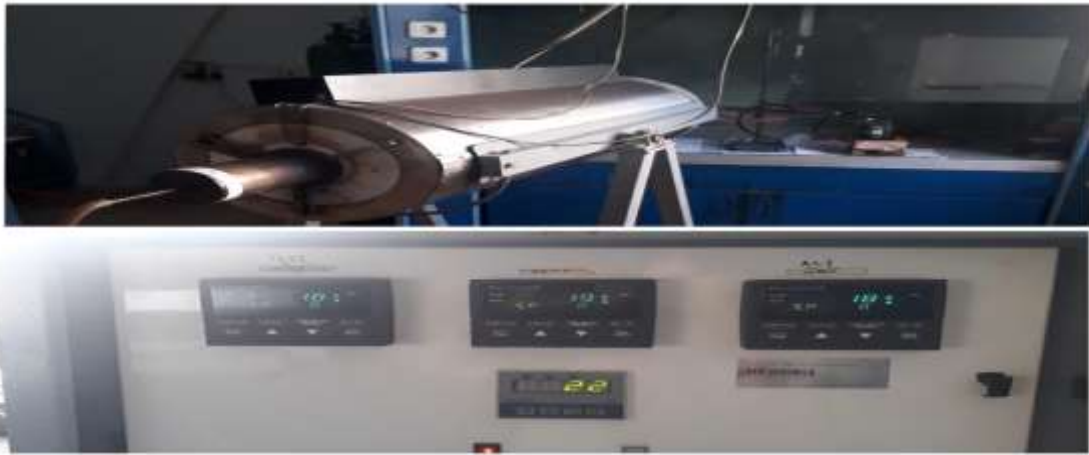
Resim 3. Karbonizasyon işleminde kullanılan yüksek sıcaklık fırını ( Ek 2 )
