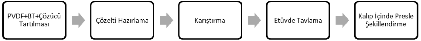
Şekil-2: Sıcak pres yöntemi ile malzeme üretim süreci
