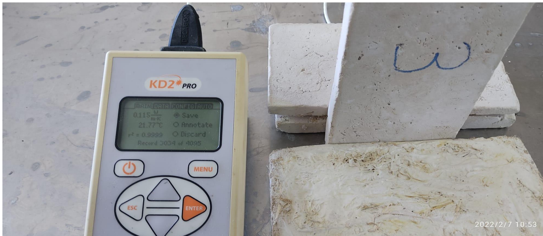
Şekil 4. Yalıtım malzemelerinin ısı geçirgenlik testi süreci
