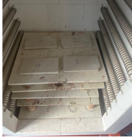
Şekil 5. Yalıtım malzemelerinin yangın dayanım testi süreci
