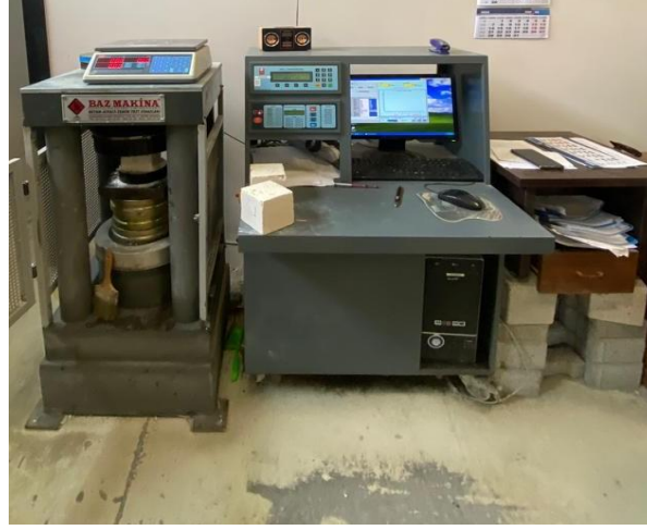
Şekil 3. Yapı malzemelerinin basınç dayanım testi süreci
