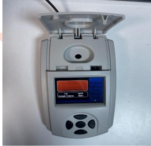
Şekil 3: Biyosensör elektrotlarının entegre edileceği ölçüm sisteminin kutusu 15x20 cm genişlik ve uzunlukta olacaktır.
