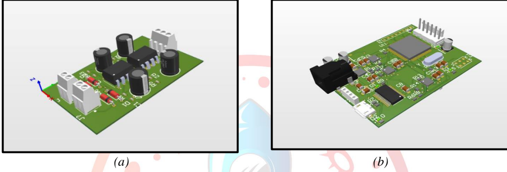
Şekil 3: Takım Tarafından Tasarlanan (a) EMG Kartı (b) Sistem Kontrol Kartı
