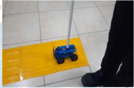
Resim 2 : Baston aparatı prototipinin engelli takip yüzeyi üzerinde kullanımı
