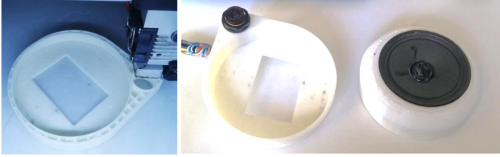
Şekil 4. 3D Basımı tamamlanmış gövde
