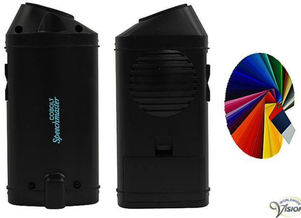
Resim 8: Cobolt Speechmaster sesli renk ölçüm cihazı (Web 1)
