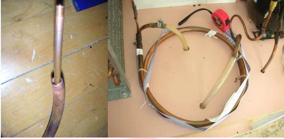
Fotoğraf-4: Atölye şartlarında imal ettiğimiz ısı eşanjörü.
