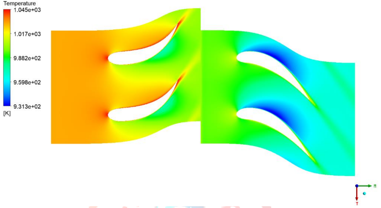
Şekil 3.64: Türbin Blade-to-Blade %50 Span Sıcaklık Konturü
