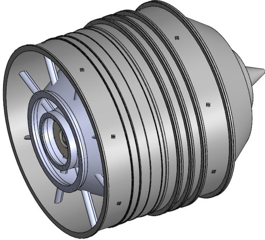
Şekil 1.1: Tasarlanan Aft-Fan Modülü
