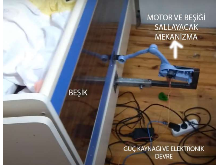
Şekil 9 . Beşiği sallayan ürün prototip görüntüsü
