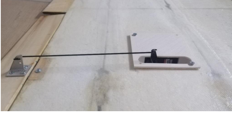
(Görsel 9, Hitec Hs-422 Servo Kanada Montajı)
