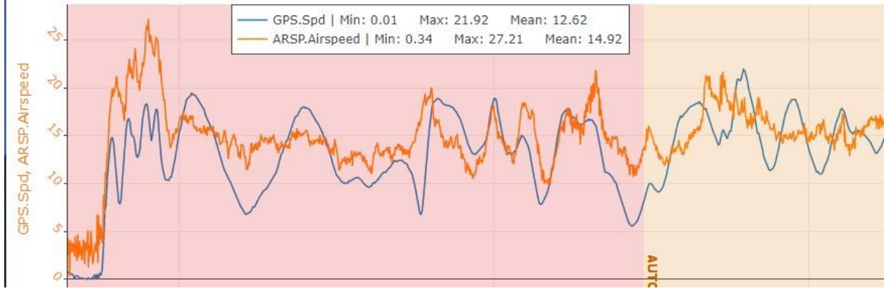
(Görsel 48, Prototip Direko İHA Uçuş Testi sırasında ölçülen Hava hızı ve Yer hızı verileri)
