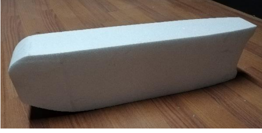
(Görsel 24, Gövde köpük kalıp)
