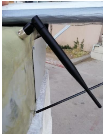
(Görsel 36, Prototip Aşağıya doğru döndürülmüş RFD-868 telemetri antenleri)
