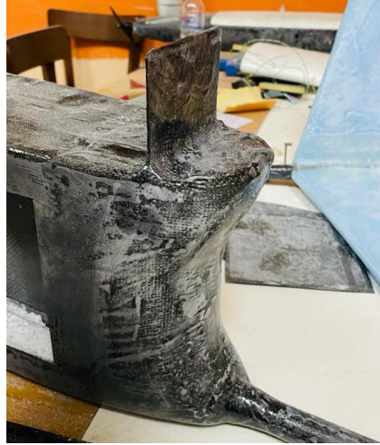
(Görsel 31, Direko İHA karbon fiber Motor yatağı)
