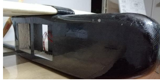
(Görsel 25, Karbonfiber kaplanmış gövde)
