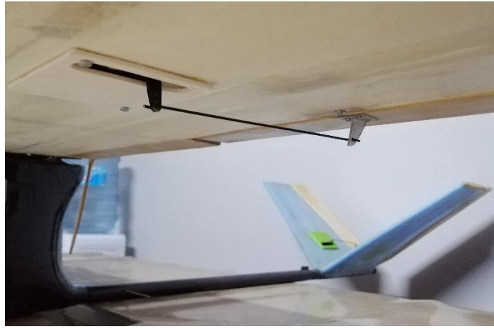
(Görsel 34, Servo-Kanatçık bağlantısı son hali)
