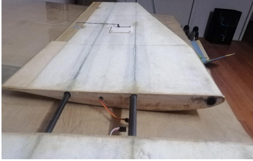
(Görsel 26, Cam elyaf kaplama kanat)
