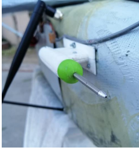
(Görsel 37, Prototip Direko İHA üzerine takılı pitot tüpü ve 3d yazıcıdan çıktısı alınmış PLA pitot tüpü yuvası)
