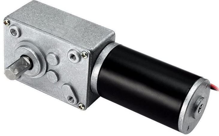
Şekil 12 - 12V 300 RPM L redüktörlü DC motor
