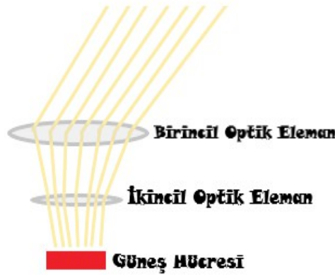
Şekil-1: Çift fresnel mercek kullanılarak yoğunlaştırılmış bir güneş hücresi.
