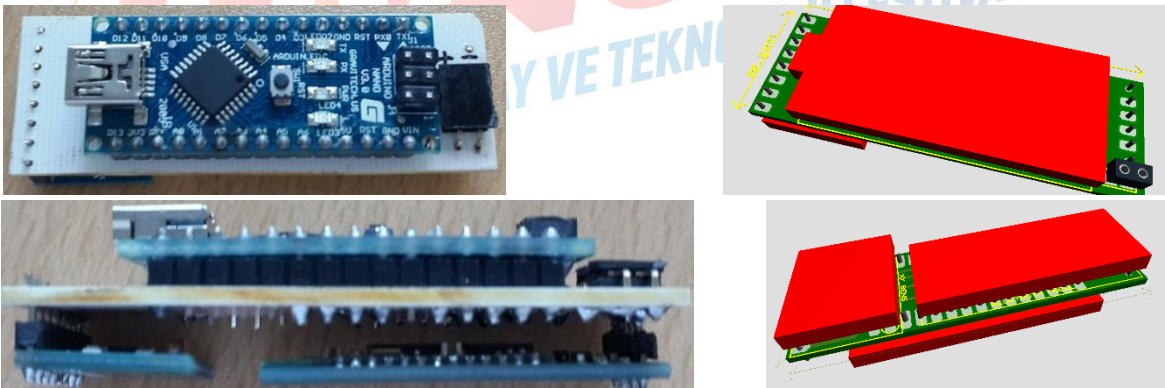
Şekil 5. Devrenin Tasarım ve Gerçek Görünümü
