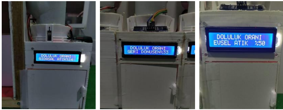
Resim 6: Doluluk oranı ölçümünün LCD ekranlar üzerinde test edilmesi
