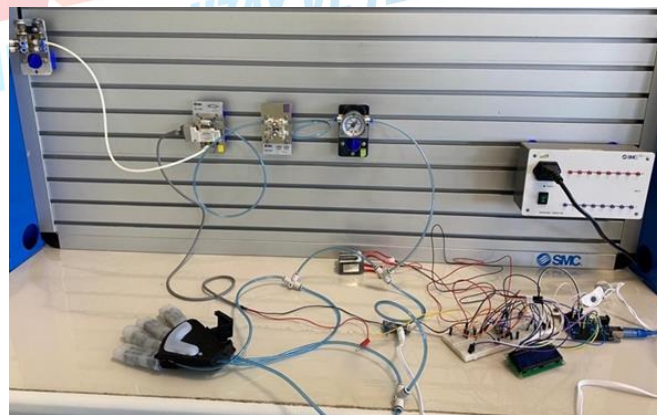
Şekil 7. Soft robotik el ve devre kurulumu
