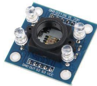
Resim 9. Sisteme ait renk sensörü
