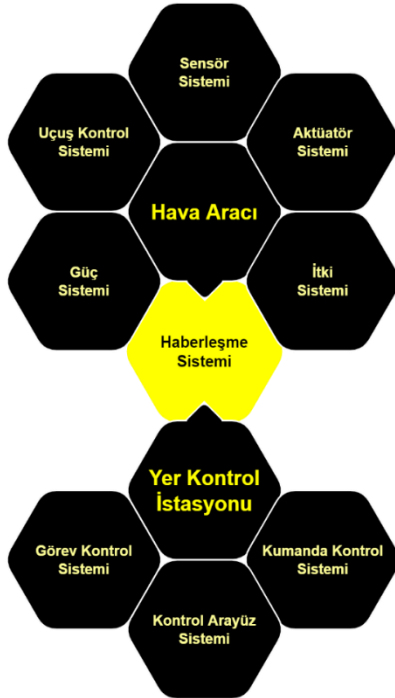
Şekil 1: Sistem Tanımı ve Özet Sistem Şeması
