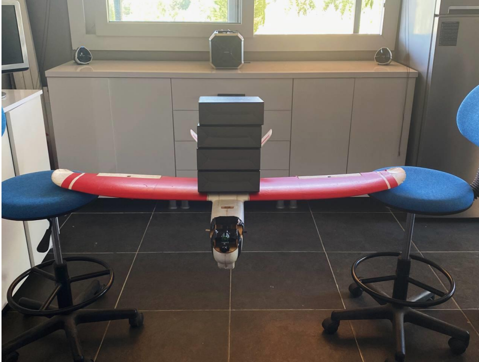
Şekil 58 Kanat Yükü Testi
