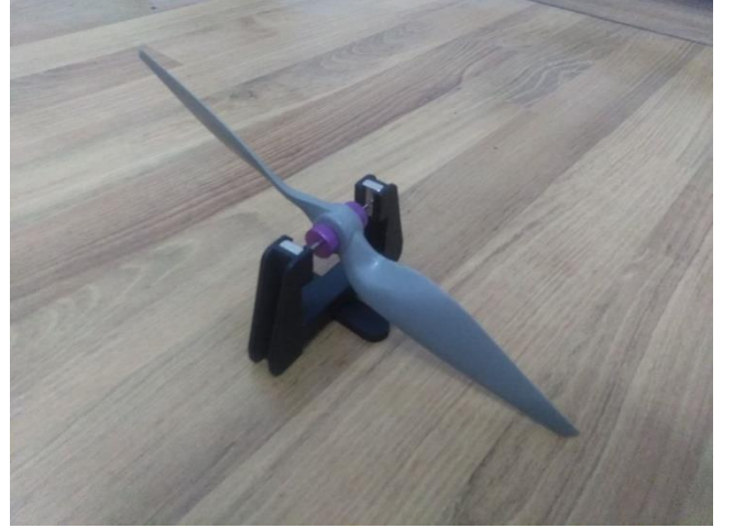
Şekil 61 Pervane Balans Testi
