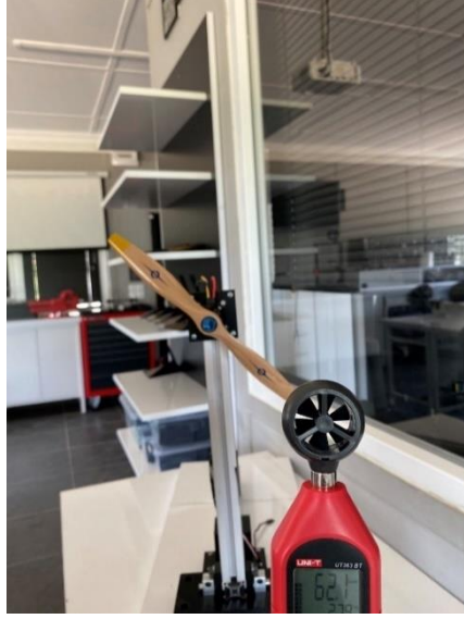
Şekil 60 Pervane Ucu Hava Hızı Testi
