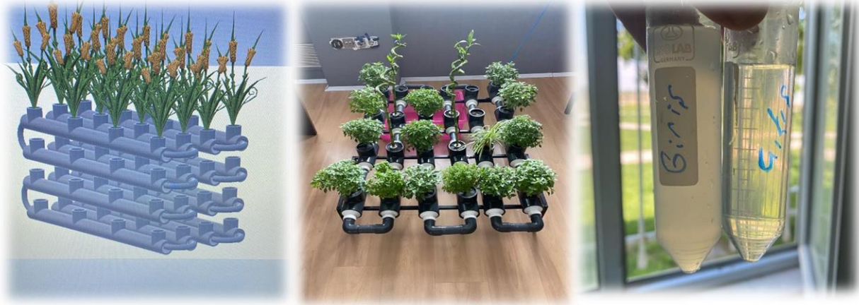
Şekil 3: Peyzaj alanlarında biyoelektrik üretimi yapabilen mega modül sistemleri ve hücrelerde yakıt kaynağı olarak kullanılan siyah suyun (sentetik kanalizasyon suyu) giriş ve çıkış görselleri.
