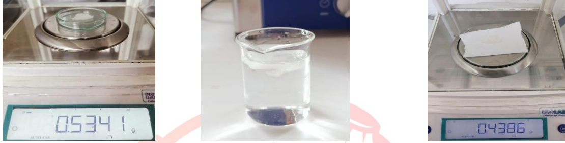
Şekil 3. Su Ortamında Biyobozunurluk Testi
