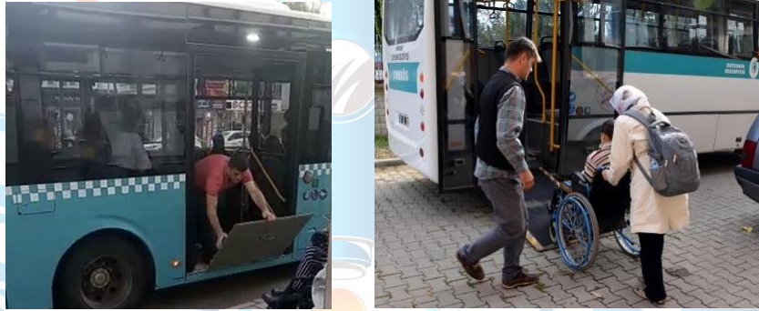
Şekil 1. Mevcut Engelli Rampası [1] [2]
