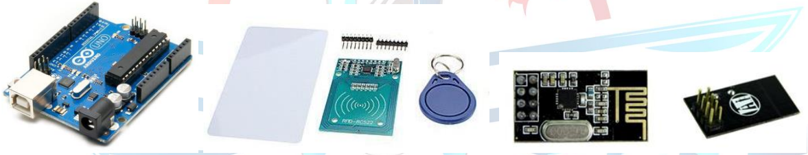
Şekil 8. Arduino Uno- RFID Kart Okuyucu- nRF24L01 Wireless Modül
