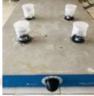
Şekil 3. Manyetik karıştırıcıda sentezlenen Anolit bileşenleri.
