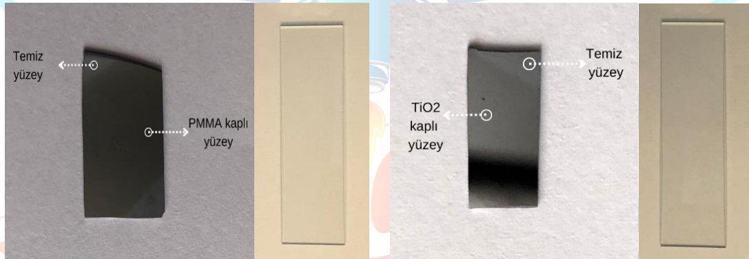
Şekil 4.1. Plazma Destekli Kimyasal Buhar Biriktirme işlemi sonrası a) polimetil metakrilat (PMMA) kaplı silikon wafer ve cam yüzeyi b) titanyum dioksit kaplı silikon wafer ve cam yüzeyi
