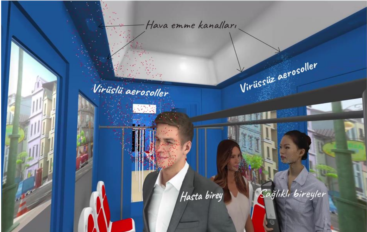
Şekil-2 Yolculuk sırasında nefes alıp veren insanların solunum yollarından çıkarak havaya karışan aerosoller (havada asılı partiküller) gaz gibi davrandıklarından bireylerin solunum yollarında çıkan hava ortamda dağılmadan emme kanalları tarafından çekilerek PASUS sisteminde temizlenip tekrar ortama verilmekte.
