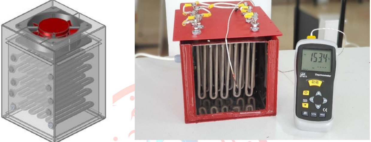
Şekil-6 Prob bağlanabilen ve sıcaklık ölçümü alan termometre ile Isıtıcı Kutusundan alınan ölçüm.
