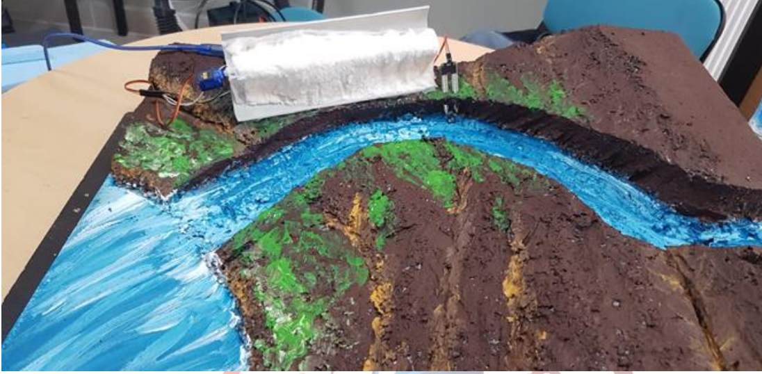
Şekil 3: Dere maketi ve Arduino Uno sistemine bağlı SAP'lı boru.
