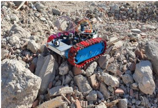
Resim 12: Kimyasal Dedektörlü Enkaz Arama Robotu Prototipinin Deney Görşeli
