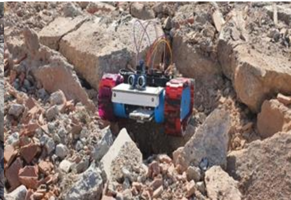
Resim 13: Kimyasal Dedektörlü Enkaz Arama Robotu Prototipinin Deney Görşeli
