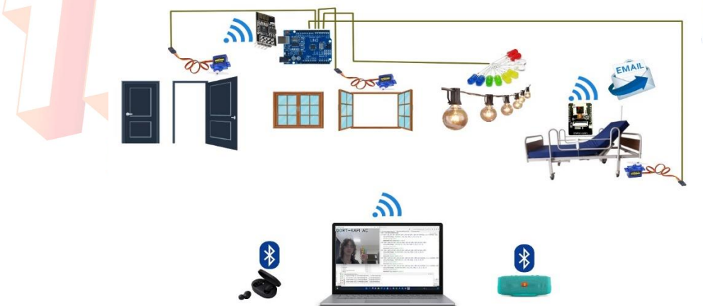
Şekil 2. Esp32'den gelen görüntünün bilgisayarda işlenmesi ile servo motor ve ledlerin kontrol edilmesi
