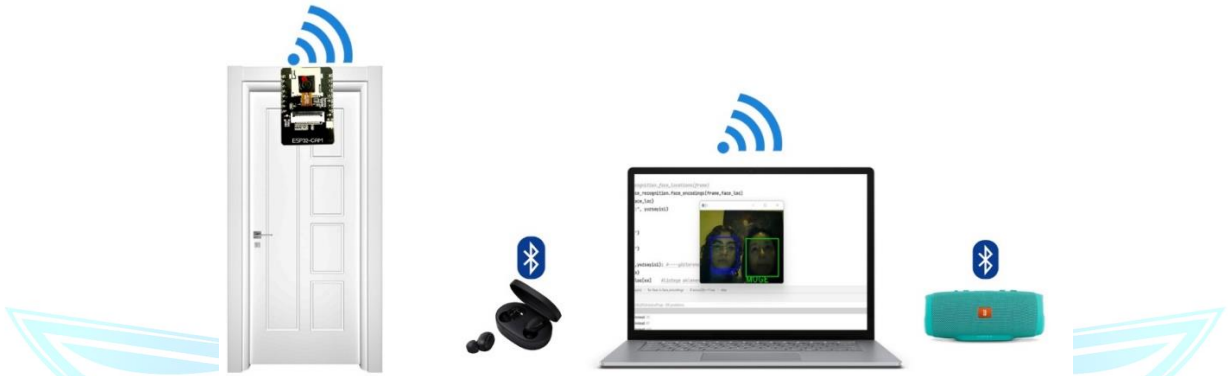
Şekil 1. Esp32 ile alınan görüntünün bilgisayar üzerinde işlenmesi ve sesli uyarı verilmesi
