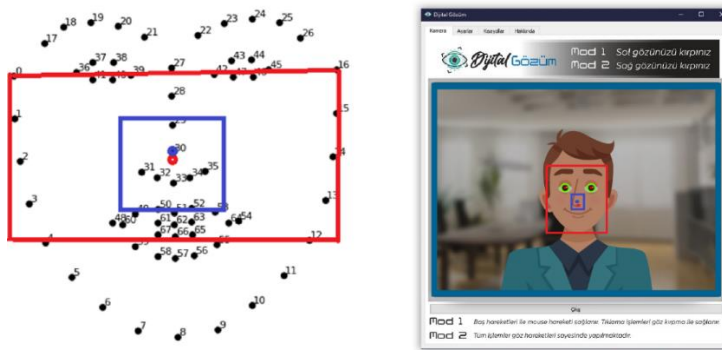
Şekil 8. Mod 1 yüz tespiti ve güvenli alan oluşturulması
