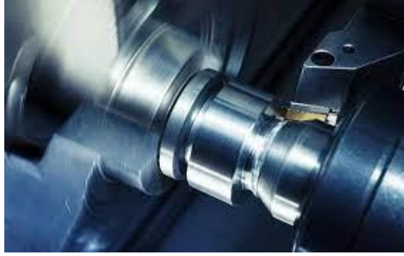
Şekil 4. 5: CNC torna ile mil işleme
