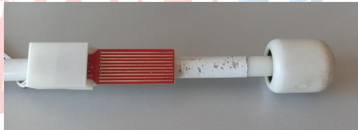
Görsel 10: Hidrobaston su seviye sensörünün montesi
