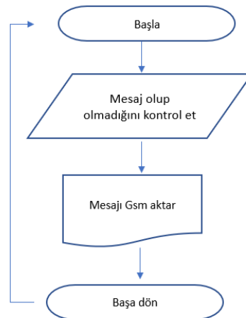
Şema 3.1.2 Merkez Gsm Aktaran Cihaz program akış Şeması
