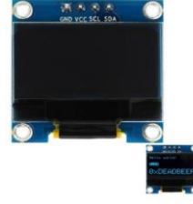
Şekil 5.2: Oled ekran(0.96 inç)
