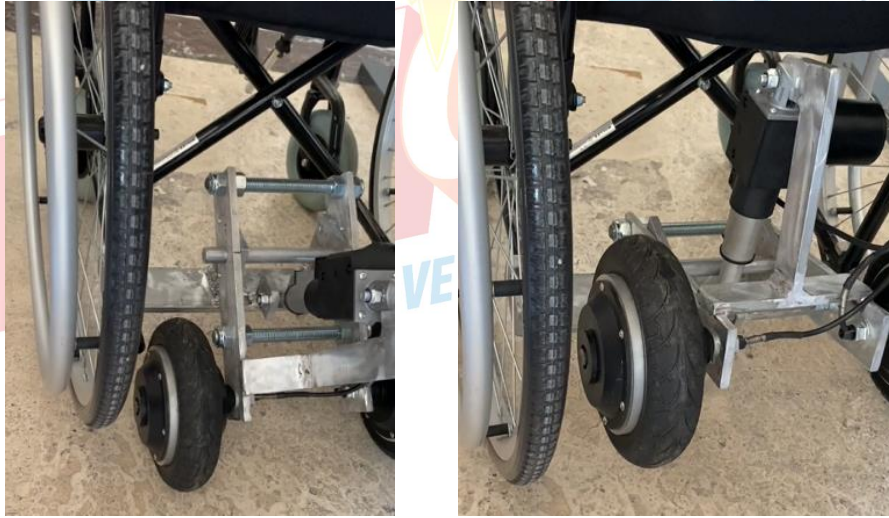
Şekil 2. Tasarlanan HTS kitinin manuel tekerlekli sandalyeye montaj edilmiş hali.
