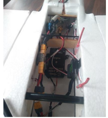
Şekil 42 - Uçuş Kontrol Kartı ve Diğer Aviyoniklerin Entegrasyonu
