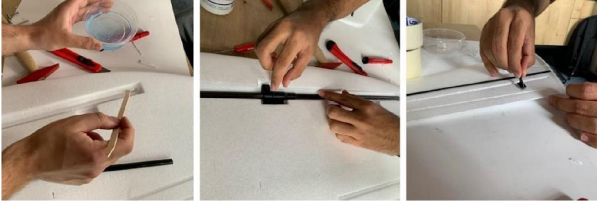
Şekil 38 - Kanat Direkleri ve Kontrol Boynuzlarının Yapıştırılması
