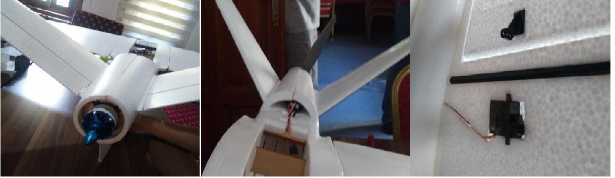
Şekil 41 - Motor, ESC ve Servo Entegrasyonu
