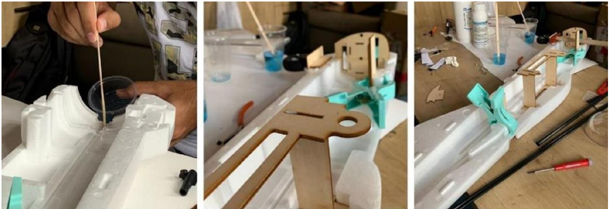
Şekil 37 – Ahşap Parçalarının Gövdeye Yapıştırılması
