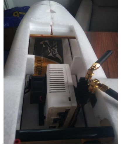
Şekil 43 - Batarya, Görev Bilgisayarı ve Telemetri Entegrasyonu
