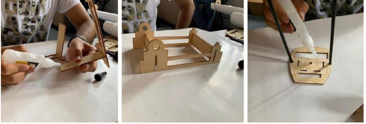
Şekil 36 - Ahşap Parçaların Yapıştırılması
