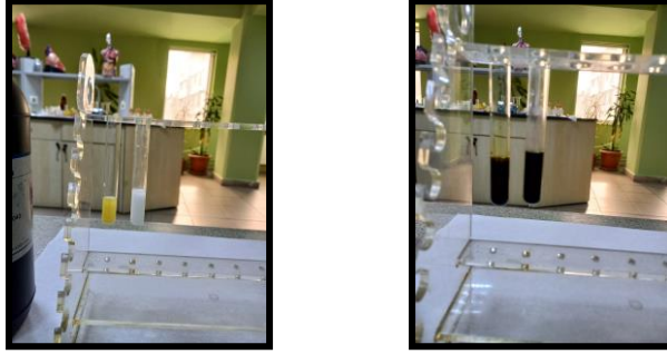
Şekil 7. Lugol Çözeltisi ile Nişasta Tayini
