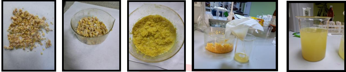
Şekil 2. Atık Mısır Koçanından Nişasta Eldesi
