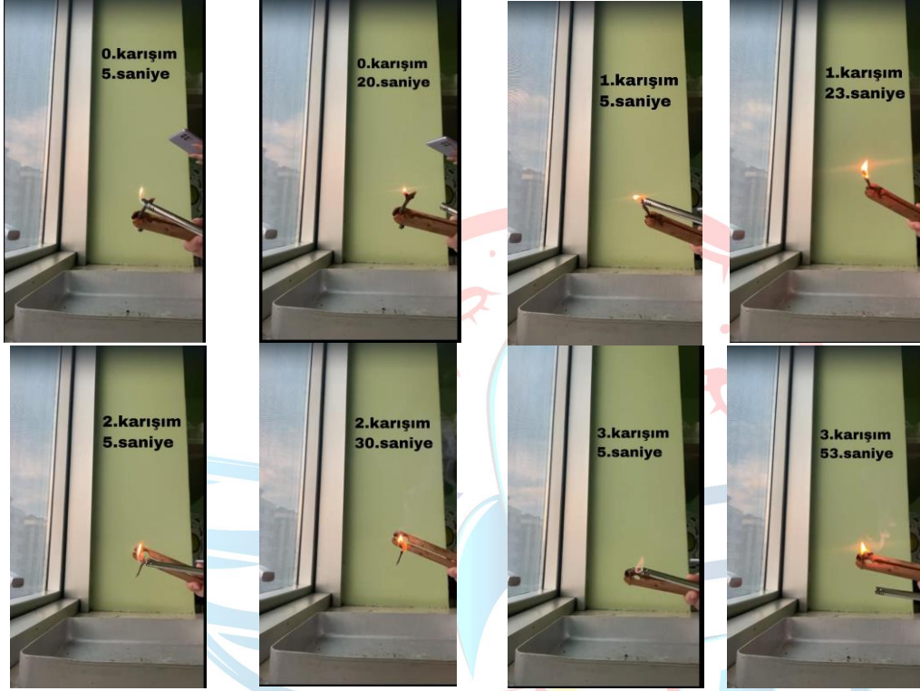
Şekil 10. Farklı oranlarda borik asit-tutkal karışımlarıyla muamele ettirilmiş meşe ağacı örneklerinin yakma testi sırasındaki farklı sürelerdeki görüntüleri
