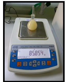
Şekil 9. Piknometre ile Yoğunluk Ölçümü
