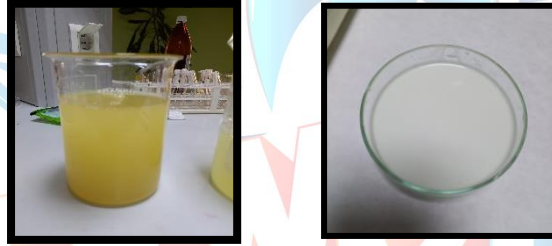
Şekil 6. Atık Mısır Koçanından Elde Edilen Nişasta
