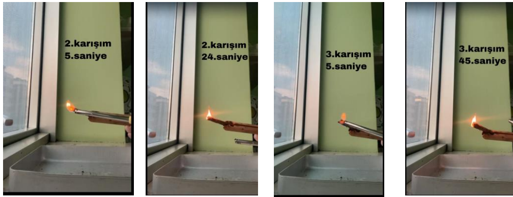
Şekil 11. Farklı oranlarda borik asit-tutkal karışımlarıyla muamele ettirilmiş çam ağacı örneklerinin yakma testi sırasındaki farklı sürelerdeki görüntüleri
