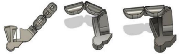
Şekil-7: Başparmak Hareketleri a) serbest pozisyon hareketi, b) tam bükülme hareketi ve c) dik bükülme
