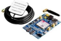
(Resim 7) SIM808 Arduino - Raspberry Pi GSM - GPS - GPRS Geliştirme Modülü. Türkiye'de yasal IMEI kaydı bulunan bu modül ile basit Telefon, SMS işlevli uygulamalardan, araç takibi, M2M uygulamaları ve aklınıza gelebilecek tüm GSM/GPS/GPRS işlemleri geliştirebilirsiniz 8 .
